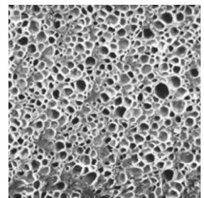
微发泡注塑成型工艺，是一种革新的精密注塑技术，微发泡注塑成型工艺突破了传统注塑的诸多局限，可显著减轻制件的重量、缩短成型周期，并极大地改善了制件的翘曲变形和尺寸稳定性。在生产高质量要求的精密制品上，微发泡注塑成型工艺具有很大的优势。
